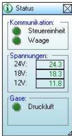
Abb. 16.1: Status – Kommunikation mit PC und Waage; Druckluft angeschlossen
