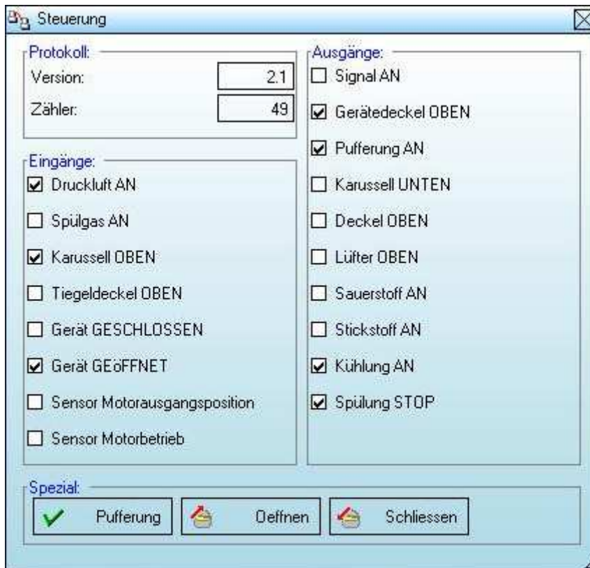
Abb. 19.1: Steuereinheit – Pressluft angeschlossen, Karussell oben, Gerätedeckel oben
